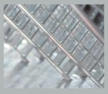
Zinkschmelze gemäß DIN EN ISO 1461 und DASt-Richtlinie 022 (Zinkbad-Klasse 1, bleifrei) für normgerechte Verzinkung und hochwertiges Aussehen der Bauteile.
